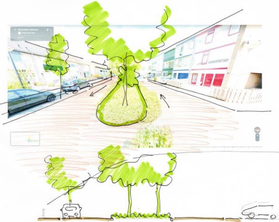
Principe profiel en 3D Abeelstraat oost Breedte profiel 18,5m -> 1,5v+5WP+6G+5WP+1,5V Voorstel: 2 Richting verkeer, gesplitst met middenberm
